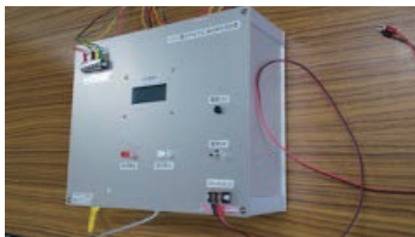
図 4-15 接地抵抗健全性確認システム
